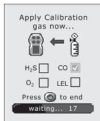
5. Сначала газоанализатор выполняет тест на газ. После обнаружения достаточного количества газа напротив каждого обнаруженного газа будет показано **■**.
